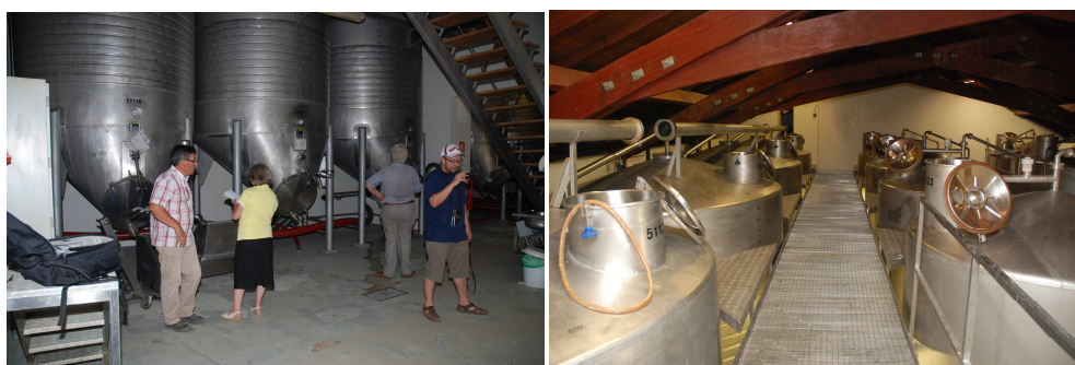
Fig. 16 - Cubas de fermentação capacidade de 15.000 litros
