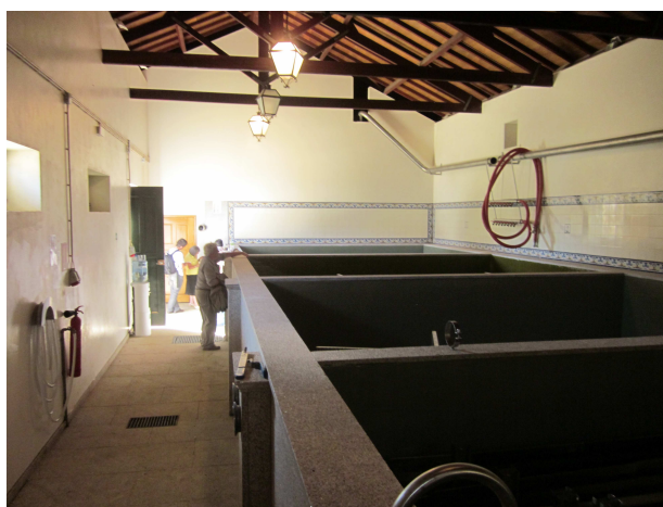
Fig. 9–Lagares de granito- capacidade simultânea 60 pipas de mosto
